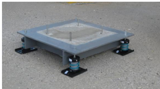
Figura 7. Bancada mixta acero-hormigón para bomba de reflujo
