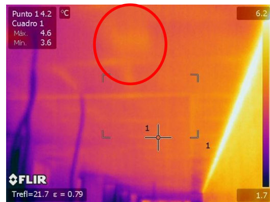
Figura 4. Puente térmico-acústico debido a que no se ha colocado material absorbente de forma uniforme en la cámara del techo suspendido.
