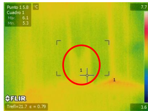
Figura 3. Defecto en la colocación de material absorbente tras la placa de yeso laminado.
